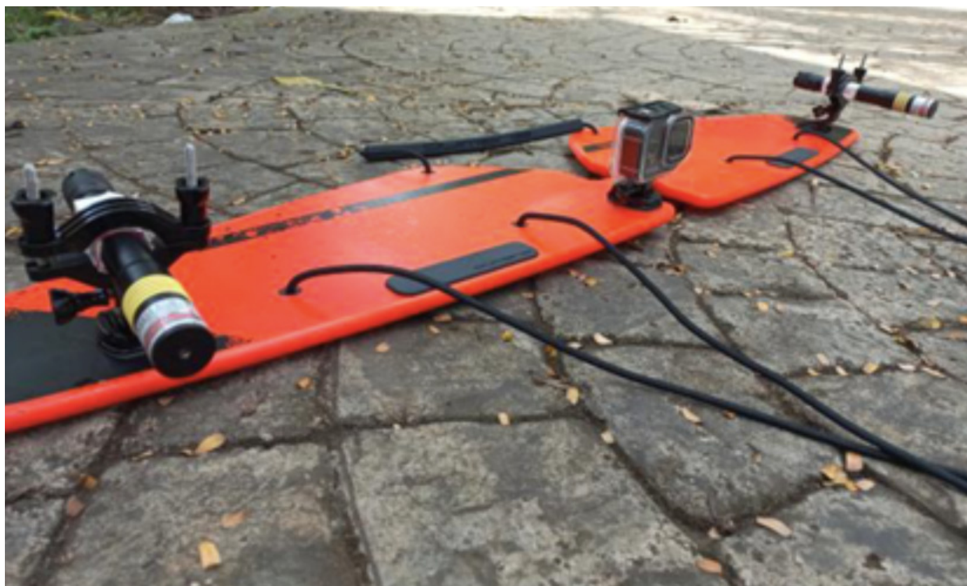
Planche "Manta tow" : outil de la technique du plongeur tracté
