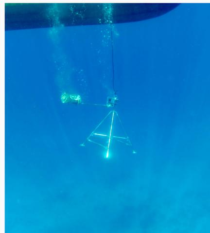
*Déploiement d'un BRUV (caméra appâtée).*
