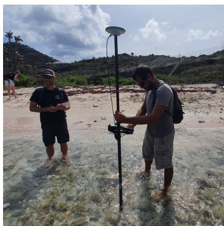
Utilisation du DGPS pour un profil de plage à Lorient
